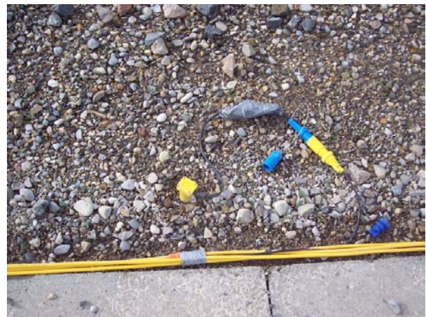
Fig. 5 : Géophone connecté à la « flûte »
